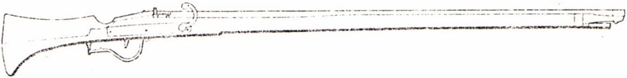
Mais l'arme fait encore des progrès: le serpentín se transformera, se perfectionnera et au lieu de tomber de l'arrière vers l'avant, on renversera le mouvement car ainsi on pourra voir plus facilement la mèche enflammer le pulvérin.
