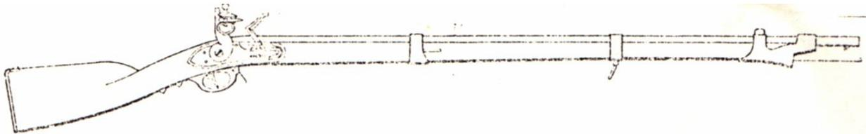
Ce système connu aussi les premières Manufactures où chaque pièce était calibrée et ajustée avec une certaine tolérance pour la rendre interchangeable avec n'importe quelle platine de même modèle. Une arme à platine de silex bien entretenue n'offre aucune difficulté d'emploi.
